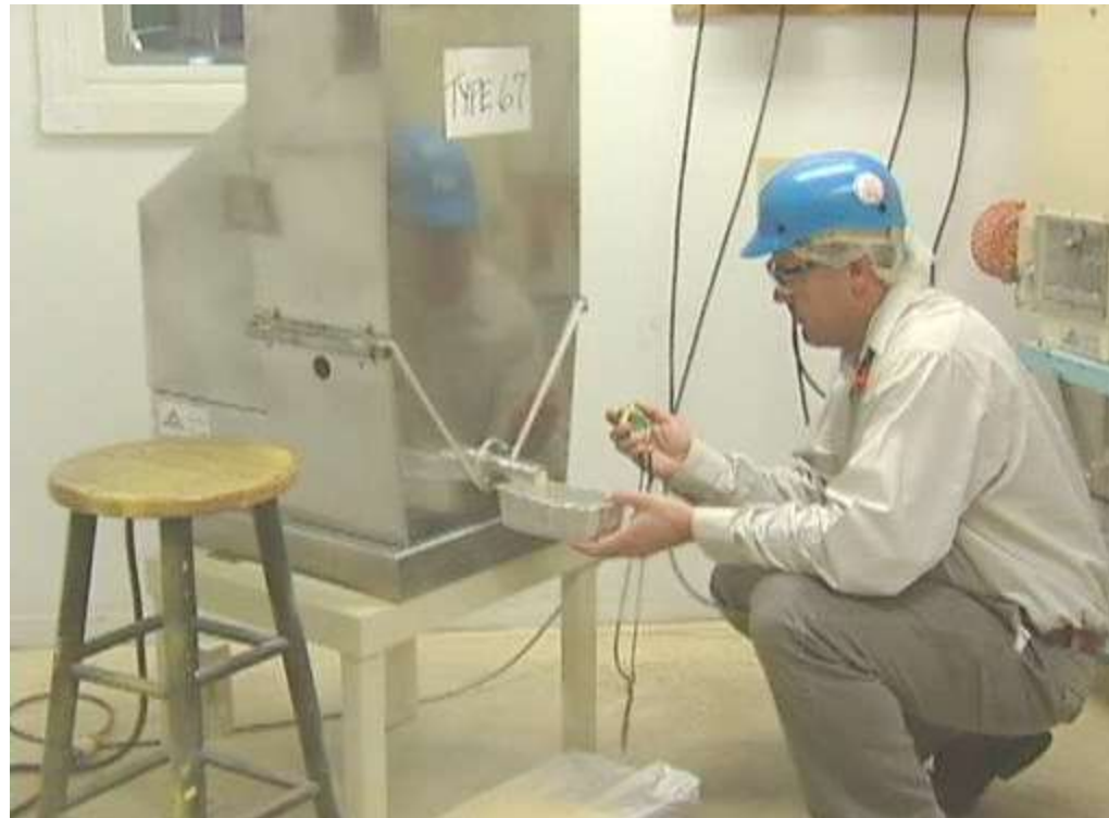
Ejemplo de Aseguramiento de Calidad: Control del flujo del dosificador
