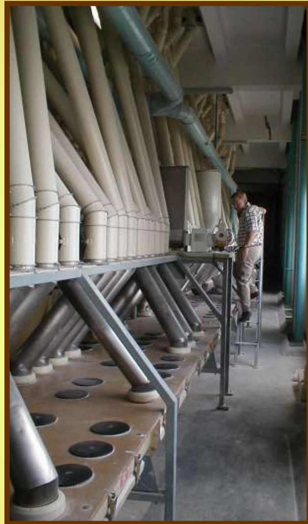
Заборные конвейеры муки для трех разных линий муки
